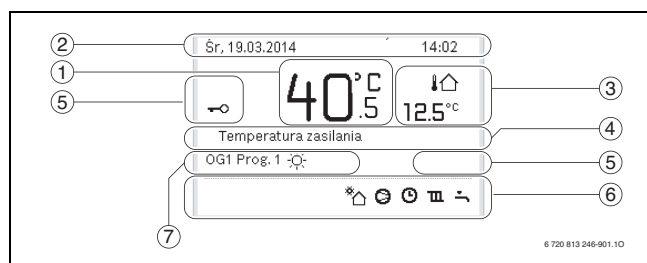
Rys. 4 Symbole na ekranie wskazania standardowego (przykładowy wyświetlacz)
